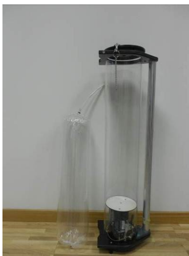
Figura 1. Campionatore passivo e contenitore in nalophan
